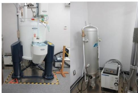
Fig.2 立入制限区域揭示と周辺重量物固定
