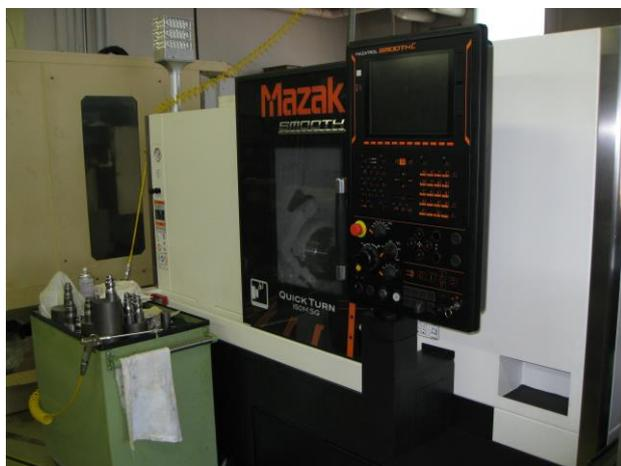
MAZAK 製 CNC 旋盤 QT150M-SG
