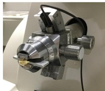
図4. 部品 B を用いたホルダへの試料の固定と装置への取り付け
