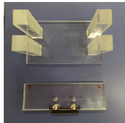
図 2. 上:台座 下:片刃をセットしたホルダー
