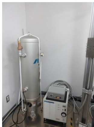
Fig.8 固定後タンク (1M 四方アルミ板上ボルト留)
