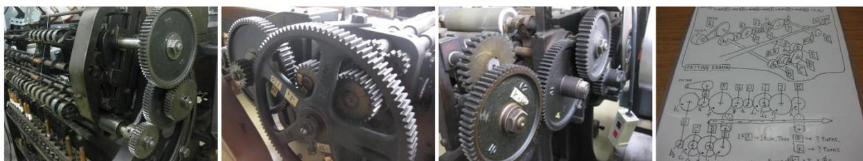
図9 精紡機の歯車列 図10 製篠機の歯車列(右) 図11 製篠機の歯車列(左) 図12 製篠機の説明書
