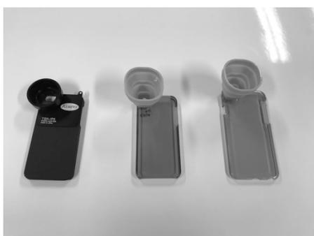
図 1. 市販アダプター(左)と製作したアダプター(中央・右)
