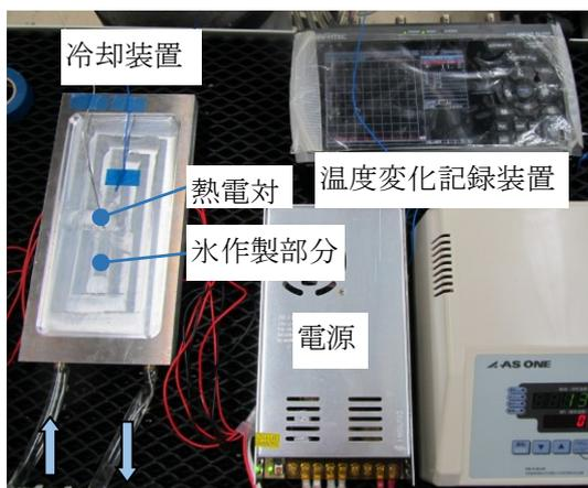
冷却水 図 6 冷却実験
