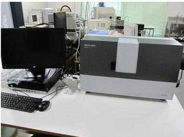
←レーザー回折式粒子径分布測定装置
