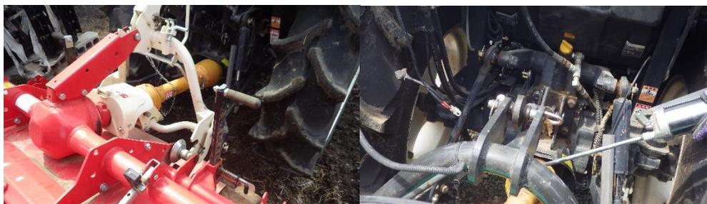
取り付け後、グリスアップしてロータリーとトラクターの接続部の摩耗を防ぐ。
