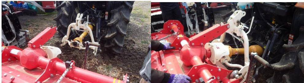
ロータリーの取り付け位置を確認しながらトラクターをバックさせドッキングの位置に来たら支持具とロータリーが外れないよう固定する。
