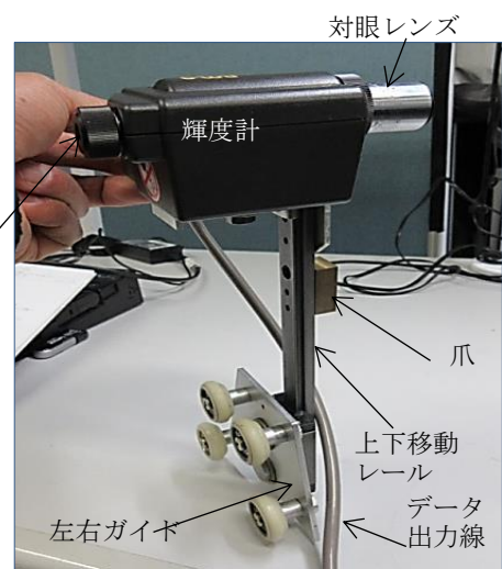
図2 輝度計と移動部 (左右移動レールから外したところ)
