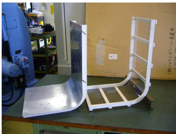
図3 組立てたアルミ椅子と塩ビ製カバー部品
