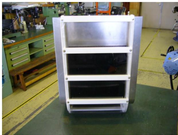
図4 冷却フィン取り付け後
