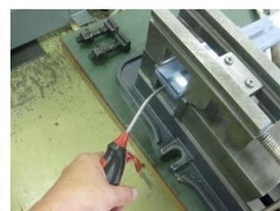
図9 エアガンによる剥離
