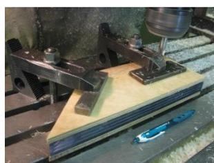
図8 エンドミルによる側壁加工
