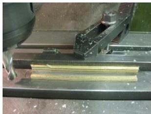
図27 抑え板の加工
