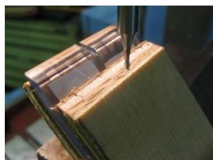
図12 エンドミルでの溝加工
