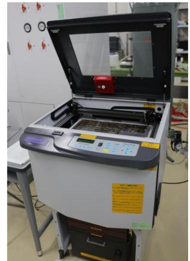
図 2 導入したレーザー加工機外観
