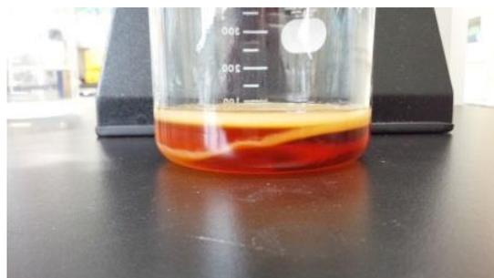
図3 培養中の攪拌により2層に分かれたBC
