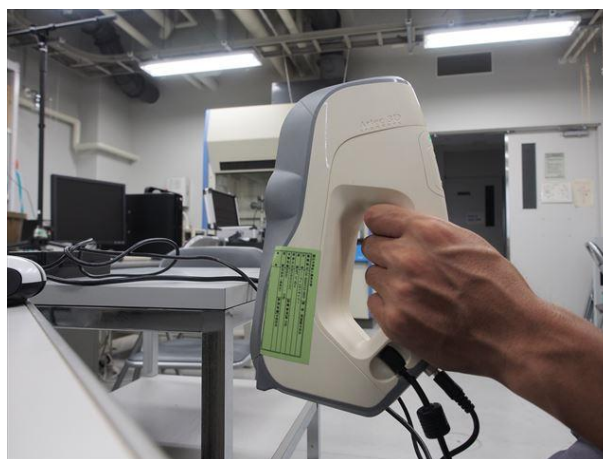
図 2 Artec Eva 3D scanner
