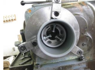
図7 チャッキングの様子
