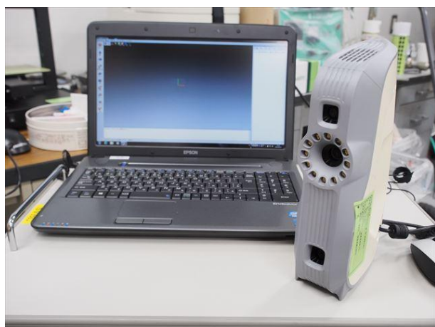
図 1 Artec Eva 3D scanner
