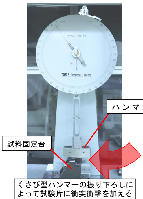
図 1 シャルピー衝撃試験装置
