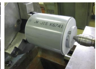
図12 芯押し台でパイプを挟む
