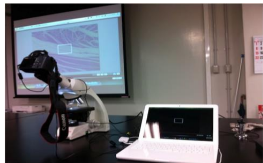
写真2. デジタル一眼レフカメラとパソコンを使った撮影システム
