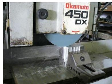
図3 アルミの研削加工
