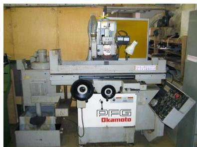
図1 精密成型研削盤
