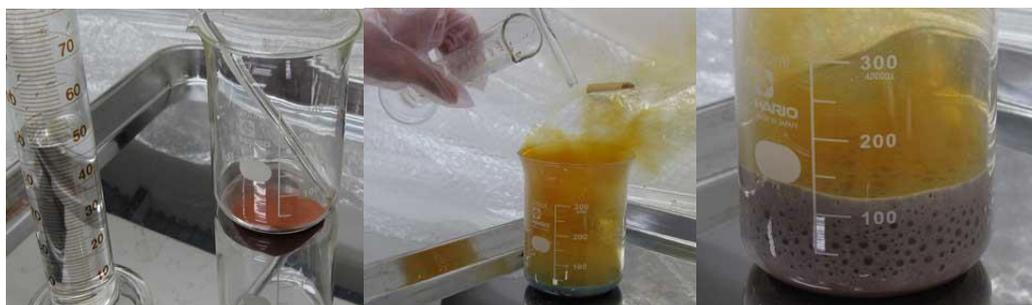
ドラフト内で銅粉 5g に 6M 硝酸 50mL を加えながら攪拌すると茶色の発煙(有毒な一酸化窒素、二酸化窒素)と反応による泡がでる。**硝酸を一気に加えると激しく反応して泡がビーカーから溢れ出し始めるので、反応の様子を見ながら硝酸を注ぐ(要注意)**。但し、あまり注意深く少しずつ硝酸を注ぐと反応が全部進まないことがあるので様子を見ながら泡が溢れ出ない程度の速度で注ぐ。
