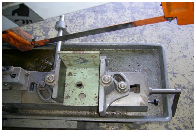
図3 アングルプレートを鋸盤バイスに固定
