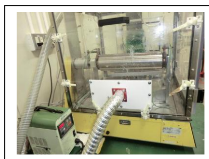
図 6 ヒートドライヤー接続後の装置
