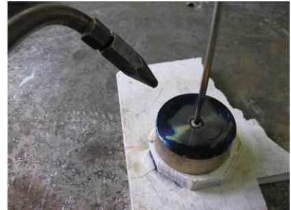
図5 バーナーで接合部を炙る
